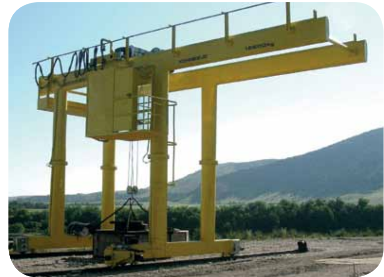
12,5 t / jib 5,4 m / patented design
